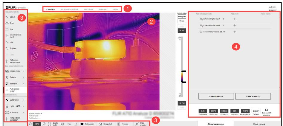
図 10.1 カメラの Web ユーザー インターフェース
